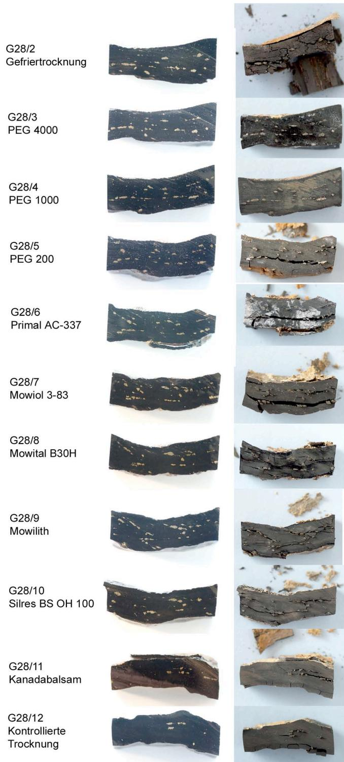
Bild 45: Die Probestücke im nassen (links) und im konservierten (rechts) Zustand. Die besten Resultate zeigen PEG 4000 und Peg 1000.
