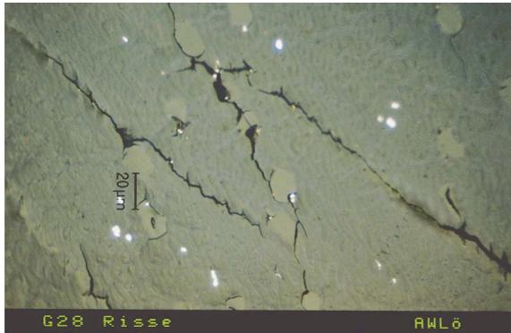
Bild 37: Mikroskopaufnahme des Probematerials. Es sind verschiedene Arten an Spalten erkennbar.
