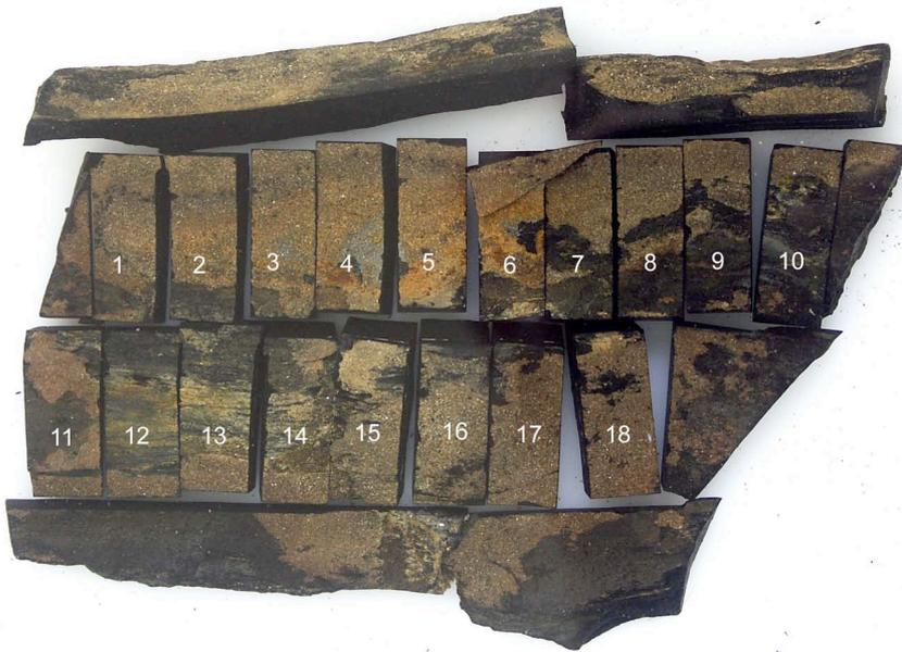
Bild 39: Zersägtes Probestück Vitrain, Nr. G28
