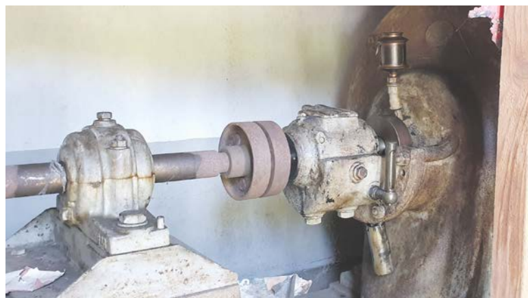
Noch funktionierendes Ventilatorwerk.
