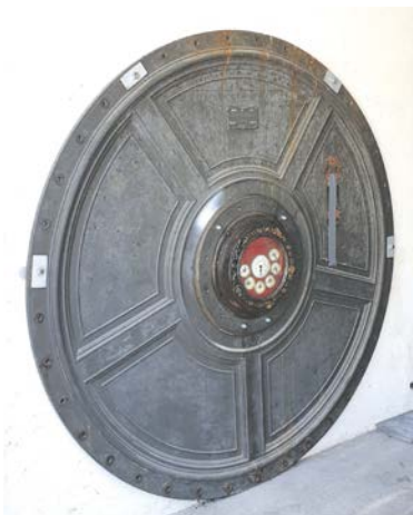
Kesselfront mit Ablesezählern zwei Metern Durchmesser.
