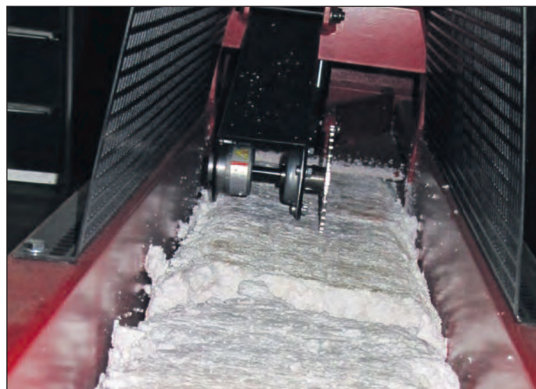
Gepresste Styroporbarren verlassen über das Vorschubrad die Anlage.
